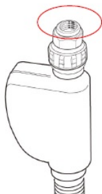
逆止弁パッキン部
